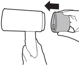
7 Fissare il serbatoio dell'acqua all'apparecchio.
