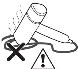
6 Non posizionare la bocchetta del sistema di stiratura a vapore sul cavo di alimentazione dopo l'uso.
