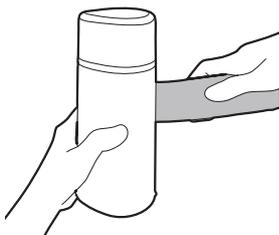
5 Piegare l'impugnatura verso la bocchetta del sistema di stiratura a vapore.
