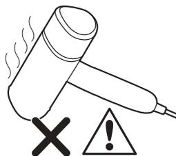
**6** Non posizionare la bocchetta del sistema di stiratura a vapore a contatto diretto con qualsiasi superficie per evitare ustioni.
