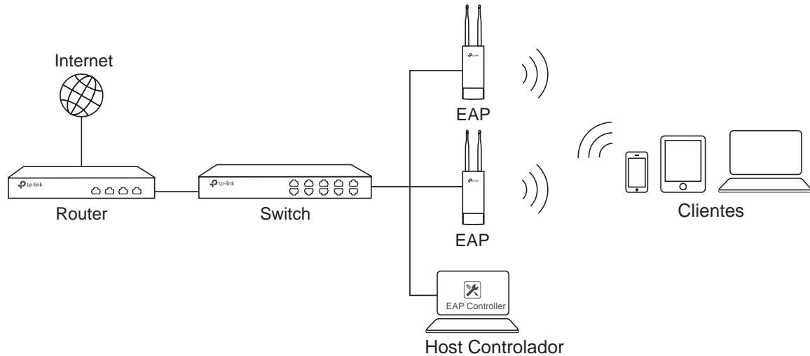
Ordenador con el software Controlador EAP funcionando, que puede estar en la misma o diferente subred que los EAPs, se utiliza como gestión centralizada de EAPs.
