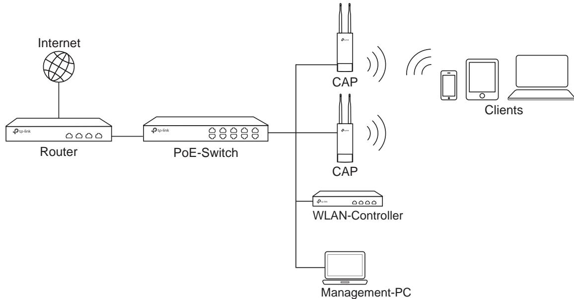
Der WLAN-Controller kann sich im selben Netzsegment oder einem anderen als die CAPs befinden. Der Management-PC wird verwendet, um sich zwecks Verwaltung der CAPs in den Controller einzuloggen.
