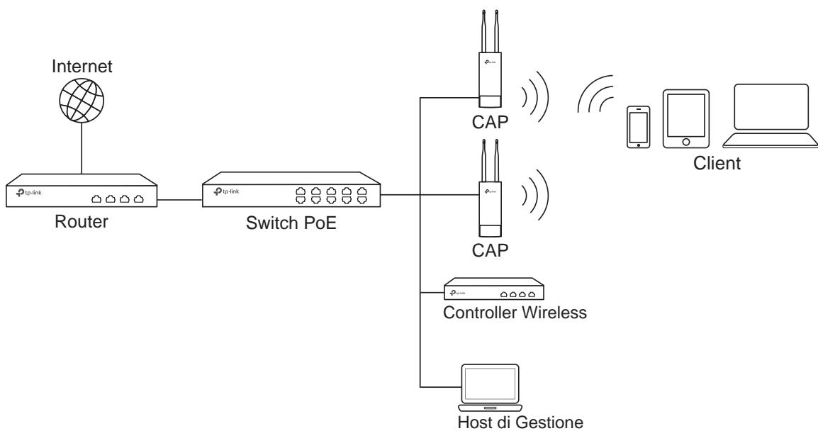
Il controller wireless può essere presente nella stessa o in un'altra subnet dei CAP. L'host di gestione viene usato per fare login al controller wireless per gestire centralmente i CAP.
