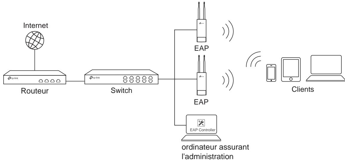
Un ordinateur exécutant le logiciel EAP Controller, pouvant être dans un sous réseau identique ou différent de celui des EAP, est utilisé pour administrer ceux-ci de façon centralisée.
