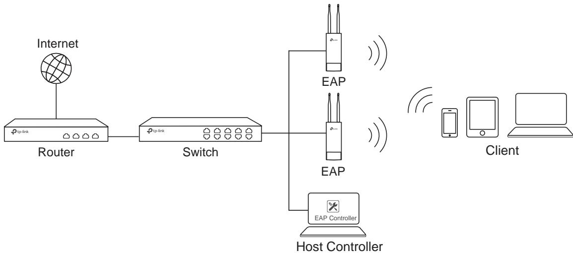
Un computer con il software EAP Controller, che può essere presente nella stessa o in un'altra subnet degli EAP, viene utilizzato per gestire centralmente gli EAP.
