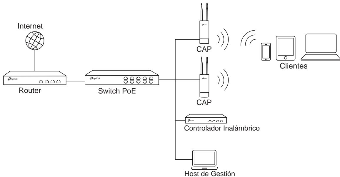
El controlador inalámbrico puede estar en la misma o diferente subred que los CAPs. El host de gestión se utiliza para acceder al controlador inalámbrico para gestionar de manera centralizada los CAPs.
