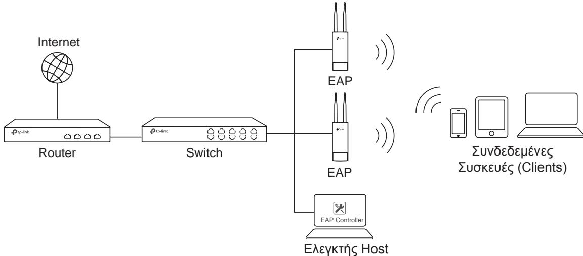
Ένας υπολογιστής που τρέχει το λογισμικό EAP Controller, ο οποίος μπορεί να βρίσκεται στο ίδιο ή σε διαφορετικό υποδίκτυο από τα EAP χρησιμοποιείται για κεντρική διαχείριση των EAP.
