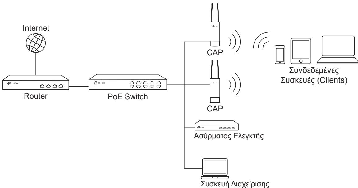
Ένας ασύρματος ελεγκτής μπορεί να βρίσκεται στο ίδιο ή σε διαφορετικό υποδίκτυο από τα CAP και η συσκευή διαχείρισης χρησιμοποιείται για είσοδο στον ασύρματο ελεγκτή ώστε να γίνεται κεντρική διαχείριση των CAP.
