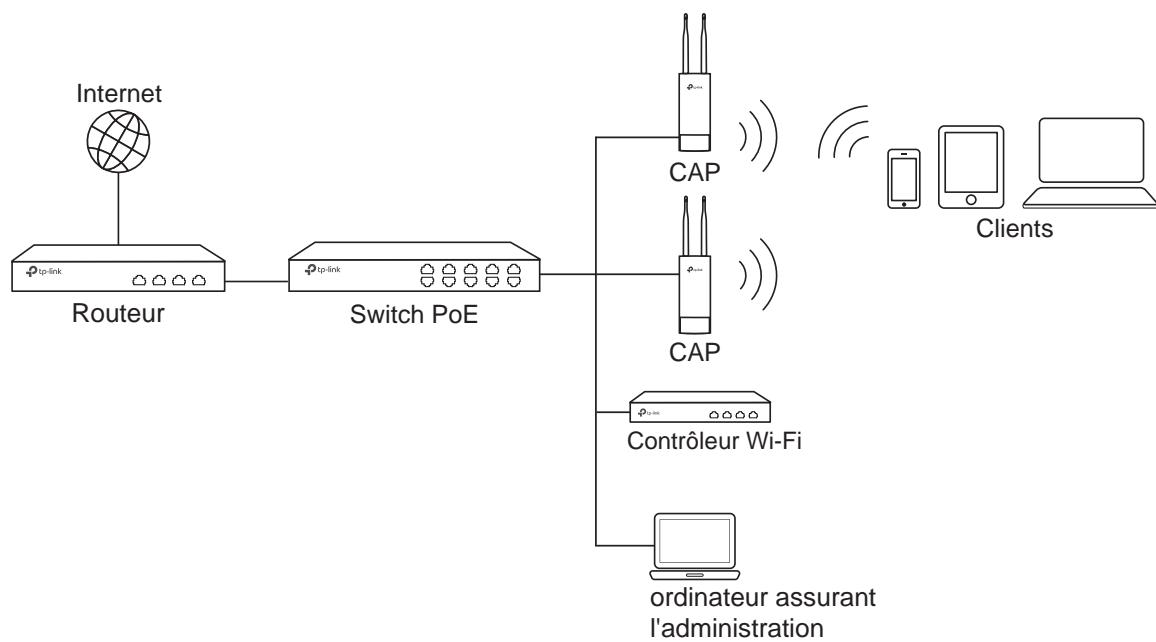
Le contrôleur Wi-Fi peut être dans un sous réseau identique ou différent de celui des CAP. L'ordinateur est utilisé pour se connecter au contrôleur Wi-Fi et administrer ceux-ci de façon centralisée.
