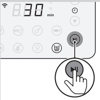
**3** Premere il pulsante di avvio/pausa per attivare la modalità di mantenimento della temperatura.
